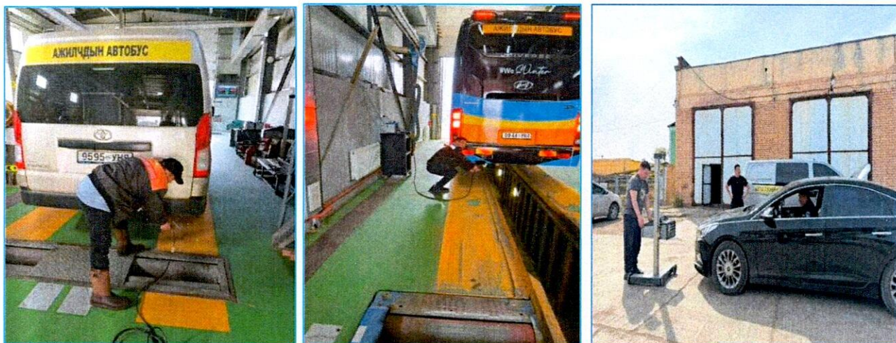
Зураг № 112. техникийн хяналтын үзлэг хийх ажлыг хийж буй байдал
